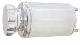
Serbatoio sfiato olio in alluminio lucidato cilindrico, raccordi inferiori push-on 10mm, capacità 800 ml. (dim. 190mm x diam. 90mm). Completo di staffa e tappo.
