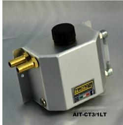
Serbatoio sfiato olio rettangolare, con livello a vista , capacità 1 Lt (dim.115 x 132 x 88mm) in alluminio satinato, entrate ed uscite da 1/4" bsp femm
