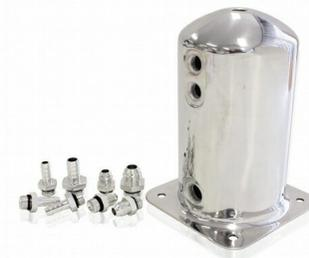
Serbatoio sfiato olio rotondo in alluminio lucidato con base appoggio, capacità 2,5 Lt. (dim. 273mm x diam. 114mm), entrate ed uscite - 8
