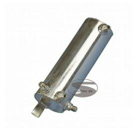
Nourice recupero sfiati olio o benzina in alluminio cilindrico , capacità 1 Lt (dim. 250mm x diam.84 mm). 4 entrata/uscite filetto-6 maschio
