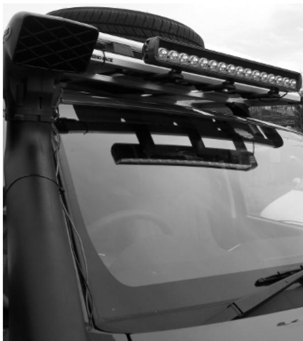
L'immagine mostra la T-16 montata su un sistema portapacchi a tetto Rhino Rack, che fornisce al conducente un'eccezionale visibilità notturna. Eliminando la dispersione della luce dal sistema a doppio riflettore ottico, la luce rimane, dove deve stare, senza il rischio di riflettere l'estremità anteriore del veicolo.
